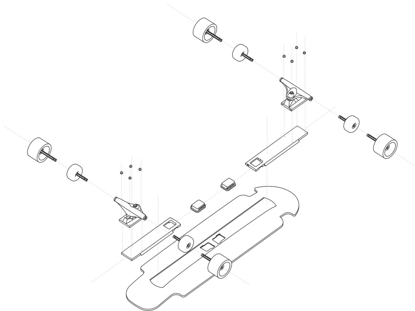
Esploso assonometrico e assemblaggio con sistema montaggio ruote
