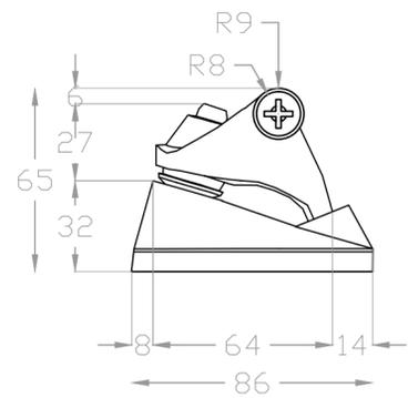
**Sezioni serratura di bloccaggio del binario**
